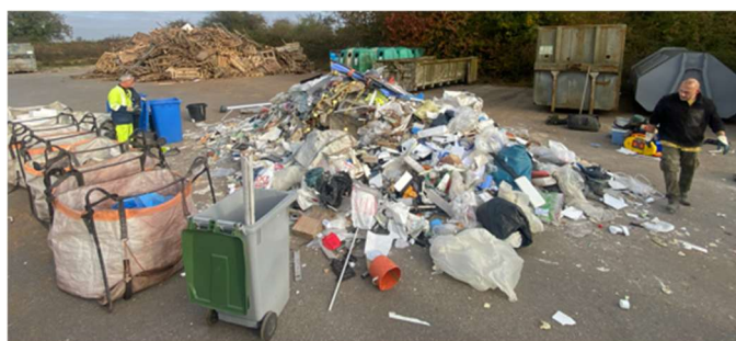
Caractérisation d'une benne Tout-Venant (tri des différents flux et pesées) – déchetterie de Feuquières
